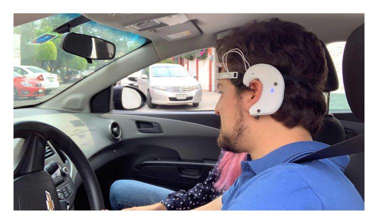
Tres egresados del Tec de Monterrey crearon 'Yapige' un sistema que detecta variables como cabeceo, parpadeo y frecuencia cardiaca en conductores para evitar que se duerman y así evitar accidentes.
