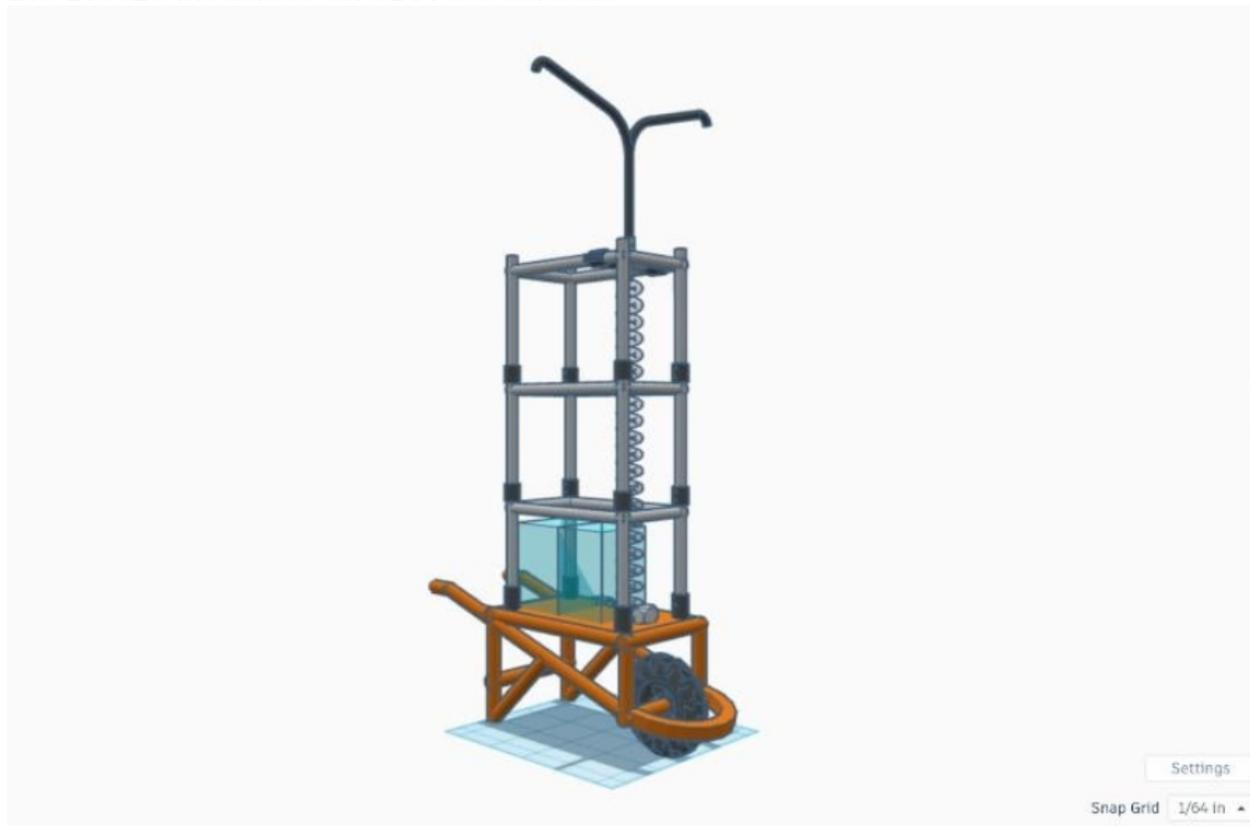
Con los datos obtenidos, se buscó una **bomba** que pudiera elevar el agua a una altura de **1.5 metros**; a partir de los cálculos de potencia eléctrica y mecánica, seleccionaron una bomba de **19 watts** como la **solución óptima**.
